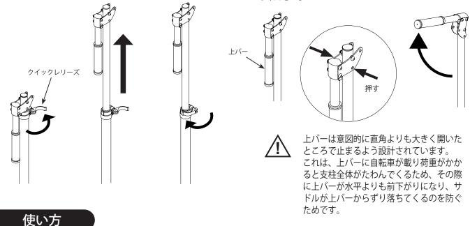
サドルのノーズ部分(シートポストよりも前の方)のサドルレールを上バーに静かに置きます。 自転車は重量バランスのせいで前輪が重みで下がります。前輪を床に着けてください。これで安定して自転車は保持されます。
