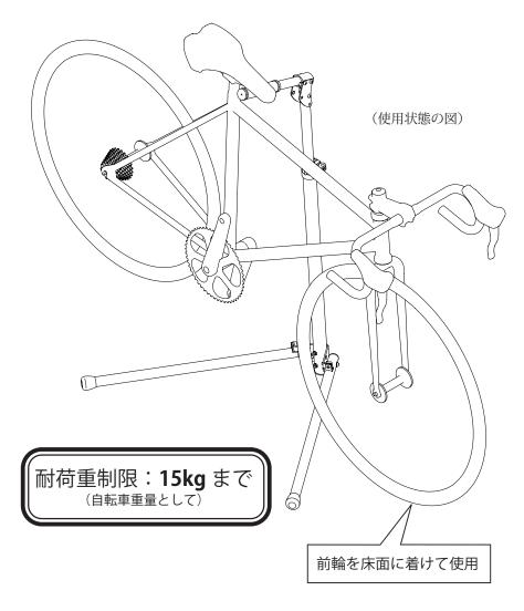
HMS-30AL は折り畳み式の簡易自転車整備スタンドで、サドルノーズを上側のバーに掛けて吊るす形で自転車を保持することで、両手を使った整備作業が簡単に行なえます。バーも脚も工具なしで展開・折り畳みができるので、持ち運びや収納に便利です。
