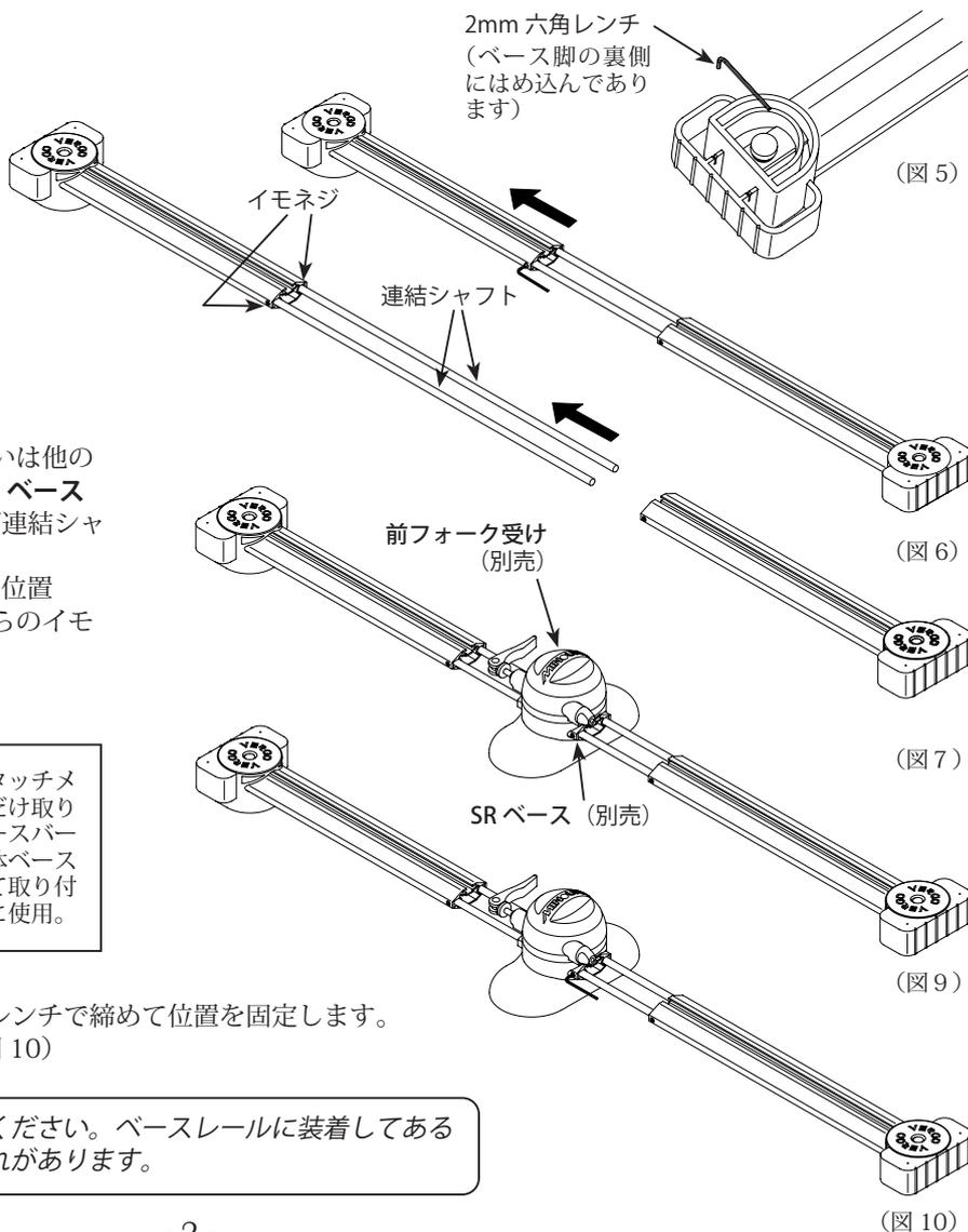
位置が決まったら、イモネジを2mm六角レンチで締めて位置を固定します。イモネジは強くは締めないでください。（図10）
