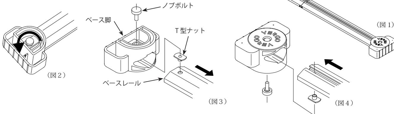
ベースレールに必要なものを通したあと、まずベースレールの裏側にある孔にT型ナットを差し込み、その状態でベース脚に挿入します。裏を見てナットのねじ孔とベース脚の孔とを合わせ、ノブボルトをねじ込んで止めます。（図4）
