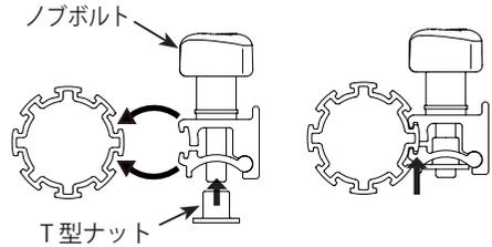
⚠ 万が一クランプが正しく締まっていなかったときに脱落してしまいます。浮かずに確実にリップを挟んでいることを必ず確認してください。
